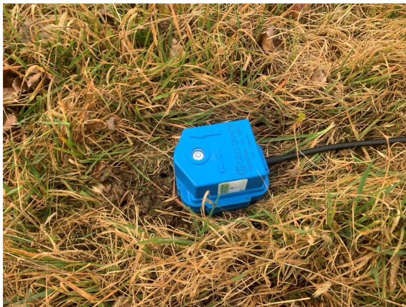
Foto n° 8: Stazione di sismica passiva HVSR_1.
