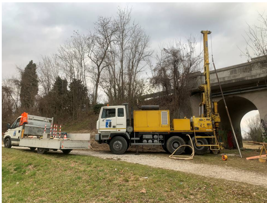
Foto n° 1: Sondaggio S1: sonda autocarrata modello "NENZI GELMA2".
